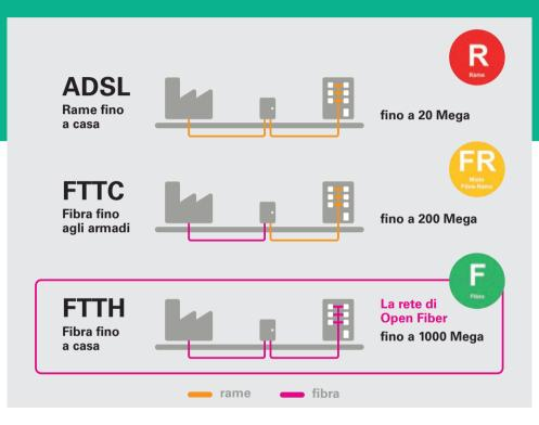
Questa rappresenta la principale differenza con le altre tecnologie di rete sia in Banda Larga che in Banda Ultralarga, dove la fibra si ferma alla centrale (ADSL) o al cabinet in strada (FTTC, **Fiber To The Cabinet**) per poi arrivare a casa del cliente sul rame, con conseguenti minori performance.
